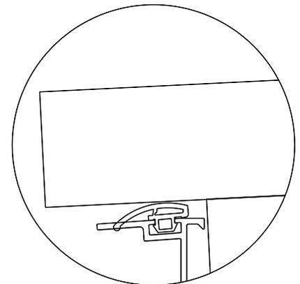
Le chevron doit être en butée sur la partie basse du chéneau.
