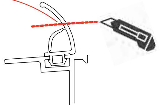
Le joint doit être écrasé sous le support de plaque
