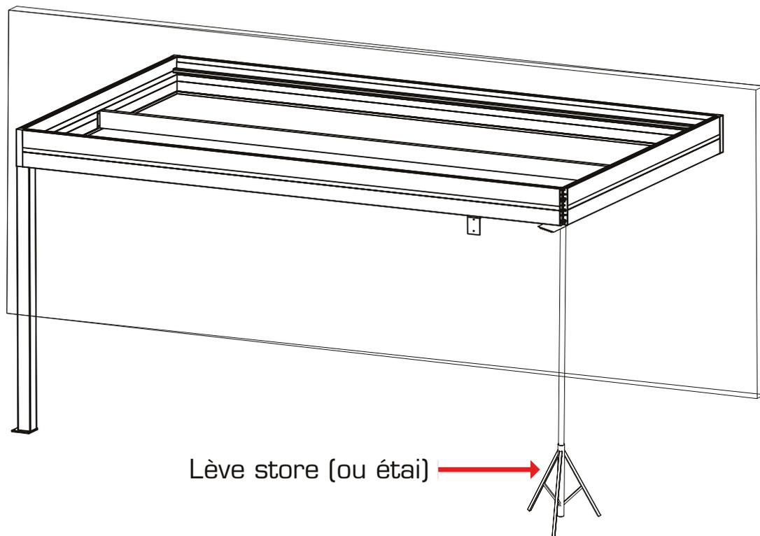
Lever légèrement la structure pour faciliter l'insertion du poteau
